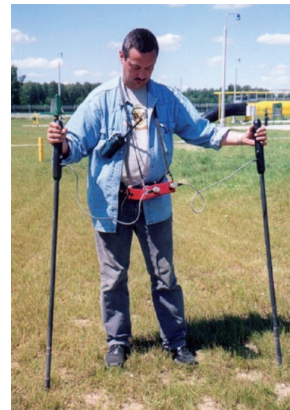
Fig. 3. Badania pośrednie – ocena stanu izolacji rurociągu metodą DCVG.
