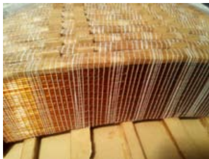
Uzwojenie nawijane przewodem CTC w oplocie siatkowym
