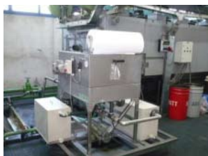
Zdjęcie 17: Filtry mechaniczne + moduły AGXX: (a) filtr ciśnieniowy/świeca filtracyjna, (b) i (c) moduły AGXX SKT + filtr magnetyczny i taśmowy
