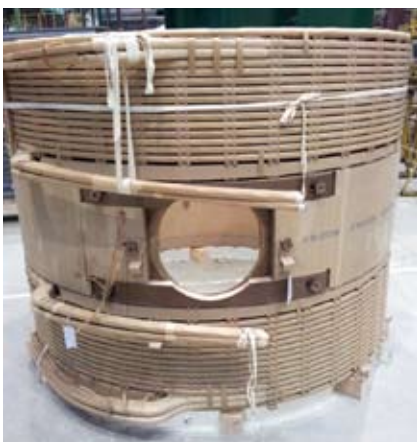
Rys. 6 Uzwojenie REG transformatora 290MVA/400kV nawijane przewodami wg technologii CTC
