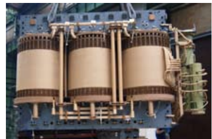
Rys. 4 a) Część aktywna transformatora TOBNRLa 290000/400 z trójkolumnowym rdzeniem, b) szczegół zaplotu wg systemu „step - lap”, c) część aktywna transformatora TOBNRLa 290000/230
