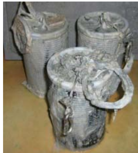
Zdjęcie 20: (a) Moduły AGXX z martwą biomasą z myjki powietrza (skrubera); (b) martwa biomasa z tokami (obróbka metalu)
