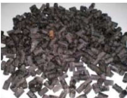
Zdjęcie 21: (a) martwa biomasa na module AGXX; (b) i (c) grube osady z martwej biomasy i innych zanieczyszczeń na pierścieniach Raschiga
