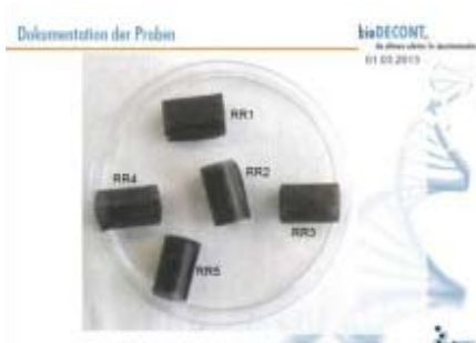
Zdjęcie 23: (a) Pierścienie Raschiga z modułu AGXX po czyszczeniu, (b) Wynik testu pierścieni Raschiga na pożywcę po inkubacji świadczy o całkowicie zachowanej aktywności antibakteryjnej.
