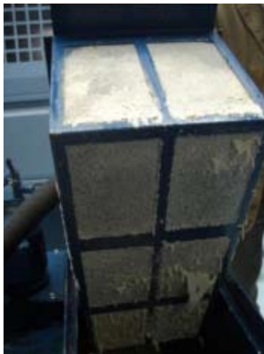
Zdjęcie 20: (a) Moduły AGXX z martwą biomasą z myjki powietrza (skrubera); (b) martwa biomasa z tokami (obróbka metalu)
