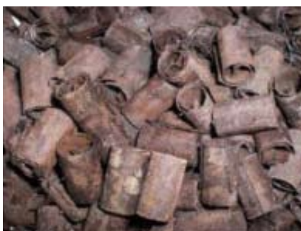
Zdjęcie 21: (a) martwa biomasa na module AGXX; (b) i (c) grube osady z martwej biomasy i innych zanieczyszczeń na pierścieniach Raschiga
