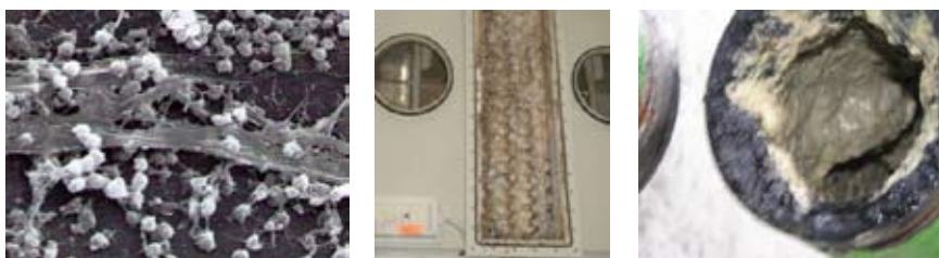
Zdjęcie 3: (a) Biofilm utworzony przez gronkowce; (b) Myjka powietrza zapchana przez biofilm; (c) Biofilm w rurociągu
