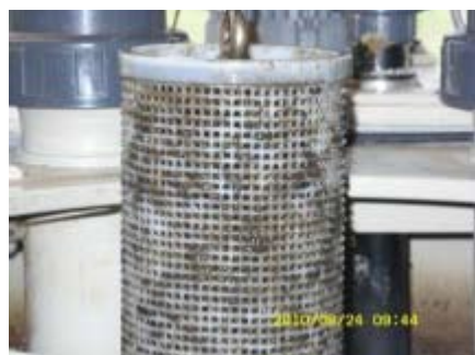
Zdjęcie 21: (a) martwa biomasa na module AGXX; (b) i (c) grube osady z martwej biomasy i innych zanieczyszczeń na pierścieniach Raschiga
