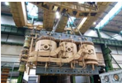
Rys. 4 a) Część aktywna transformatora TOBNRLa 290000/400 z trójkolumnowym rdzeniem, b) szczegół zaplotu wg systemu „step - lap”, c) część aktywna transformatora TOBNRLa 290000/230
