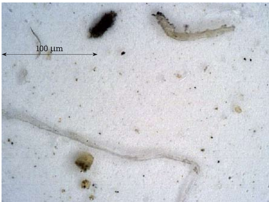
b. Włókna celulozy, które otoczone przez drobiny wody mogą stawać się cząstkami przewodzącymi
