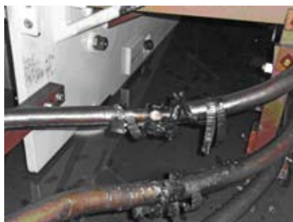
Fot. 2. Ślady wypalenia na odpływach fazy A i B biegnących do wyprowadzeń na klatce wybierakowej przełączników zaczepów – widok po otwarciu transformatora i odizolowaniu żył
