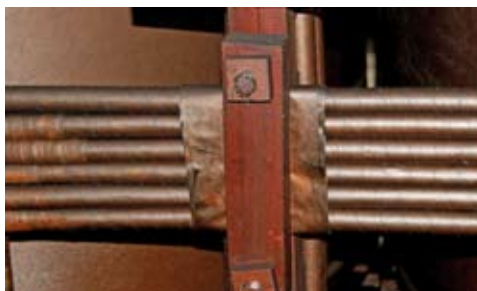
Fot. 3. Osad złożony z produktów zesterzenia oleju zalegający na części aktywnej transformatora o długoletniej eksploatacji. Obok widok (powiększenie 100-krotne) osadu na papierze izolacyjnym zdjętym z uzwojenia regulacyjnego
