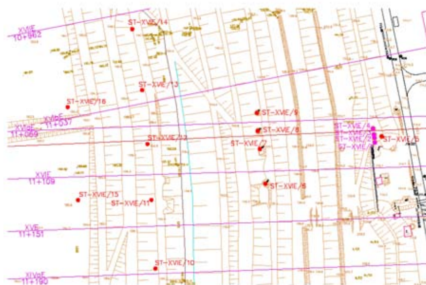
Rys. 7. Lokalizacja studni odciążających w rejonie przekroju XVIIE
