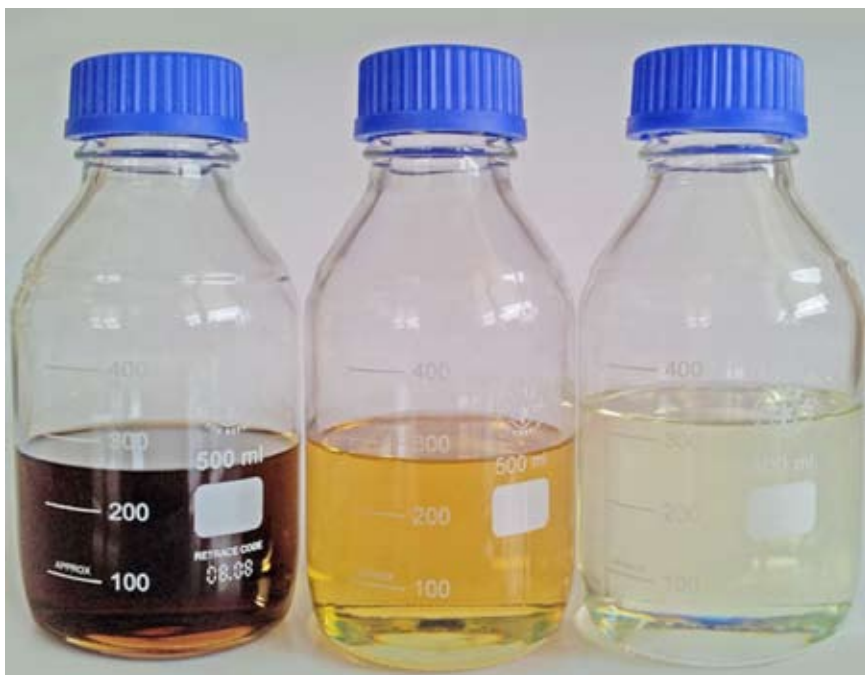
Rys. 9. Widok próbek oleju przed i po zakończeniu regeneracji
